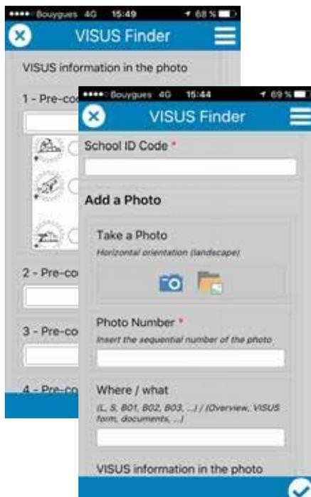
图 3: VISUS 应用程序允许经过专业培训的检测人员对学校设施进行多灾害、快速目测筛查等调查，从而确定学校设施结构性缺陷。VISUS 工具生成包括安全升级费用预算在内的总结报告。
